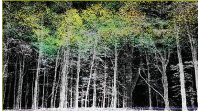
Figuur 3: Scan met LiDAR punten uit een combinatie van een vliegtuig-gebaseerde LiDAR opname (punten in kleur) en een grond-gebaseerde LiDAR opname (punten in grijswaarden). De driedimensionele structuur van de bomen wordt hierdoor bepaald. (bron: RSL, University of Zurich)
